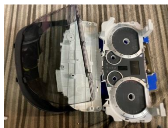
基板を取り出したケース (PP・PMMA類)
