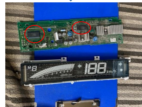
強引には有るが、基板分離可能。 表示部分は樹脂、ガラス製で重量が有る ため、必ず分離除去をする。
