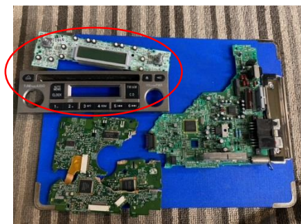
基板取り出し コントロールスイッチ 部分は、IC装着無しのため省く。
