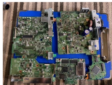
基板取り出し
