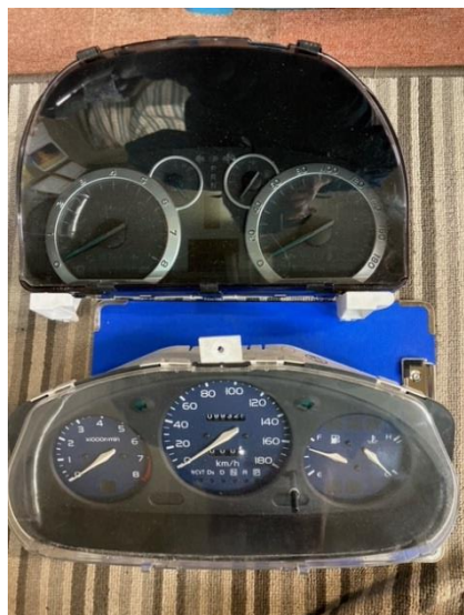
上 メーターユニット新 (トリップメーターデジタル式) 下 メーターユニット旧 (トリップメーター機械式)
